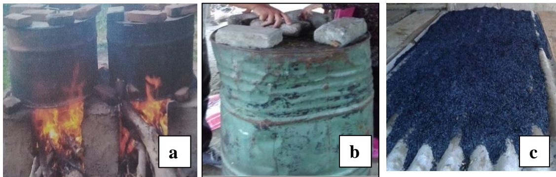
Gambar 3. Teknik Pembuatan agrichar dengan; a) menggunakan tungku; b) Drum ditutup; c) Agrichar siap diaplikasikan
