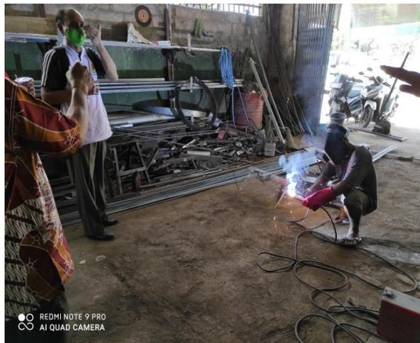
Gambar 7 Penggunaan APD langsung di pakai untuk pengelasan di Bengkel
