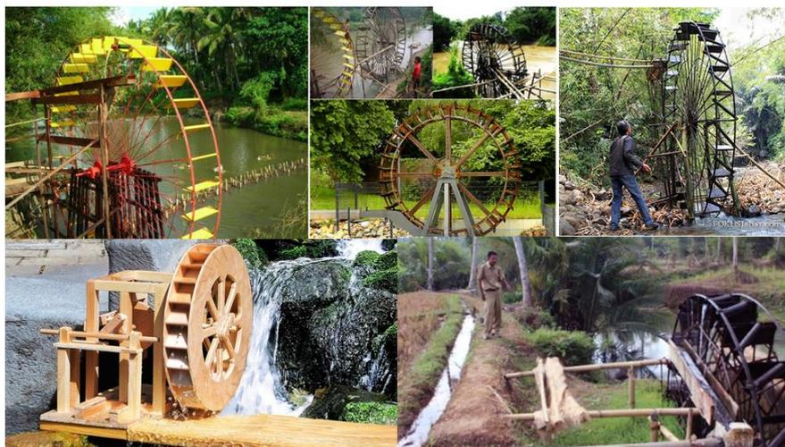
Gambar 4. Contoh-contoh kincir air untuk mengkonversi energi air menjadi energi guna atau listrik atau untuk menaikan air dari sungai.
