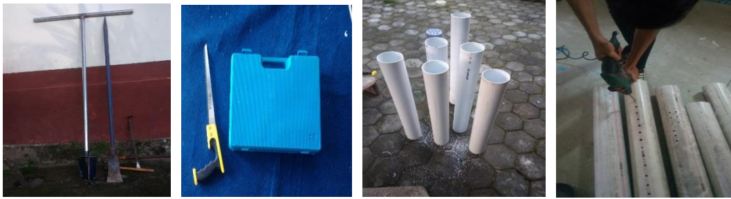
Gambar.4. Alat bor tangan dan Bahan pipa PVC
