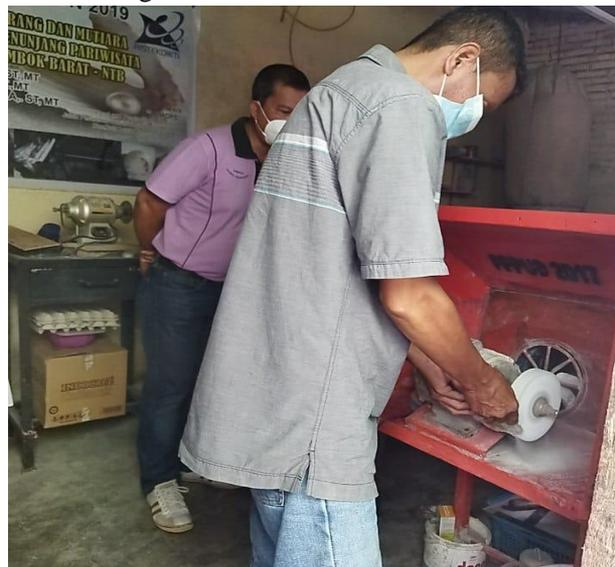
Gambar 4 Mesin sedang di coba untuk mengikis lapisan luar kulit kerang, debu2 yang ringan langsung terisap oleh mesin, kemudian debu yang berat bisa di bantu dengan kuas untuk mendorong ke mesin penyedot.
