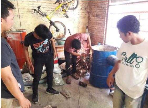
Gambar 7 Mahasiswa terlibat dalam memodifikasi wadah Penampung Debu, terbuat dari Drum yang akan di pasang Kain Drill
