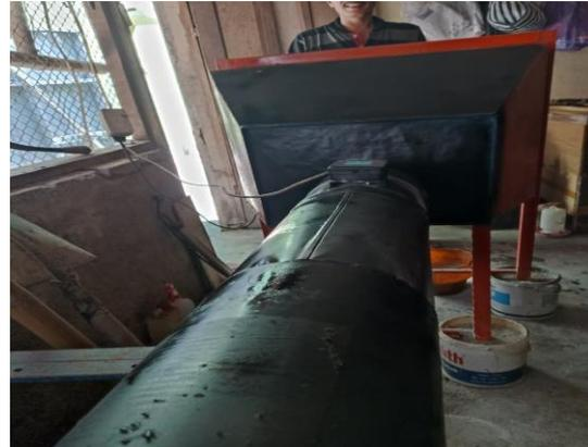
Gambar 8 Proses pengecatan Saluran debu dan bagian mesin sedot debu dalam saluran.
