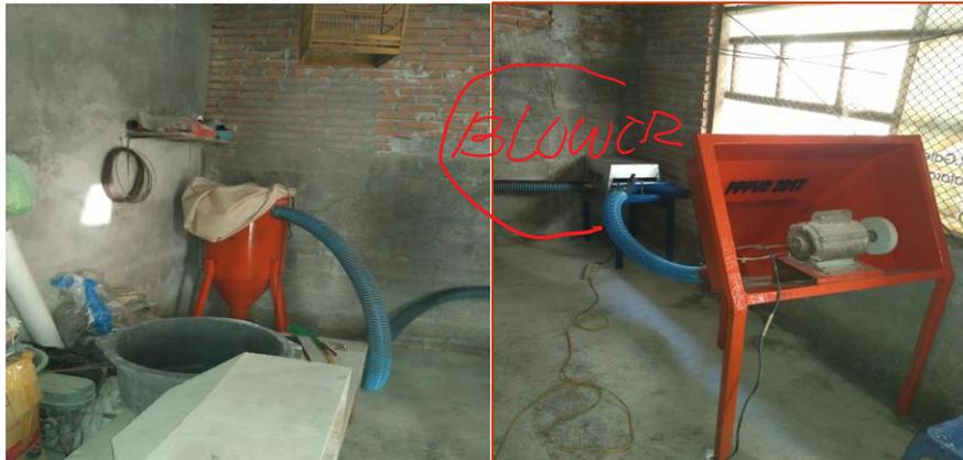
Gambar 1 Instalasi penyedot debu yang sudah ada sebelumnya, memakai Blower dan slang Spiral
