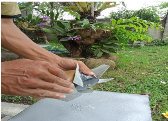
Gambar 5 Tim Pengabdi sedang mengampleas suhu axial yang baru selsai di buat untuk persiapan pengecatan
