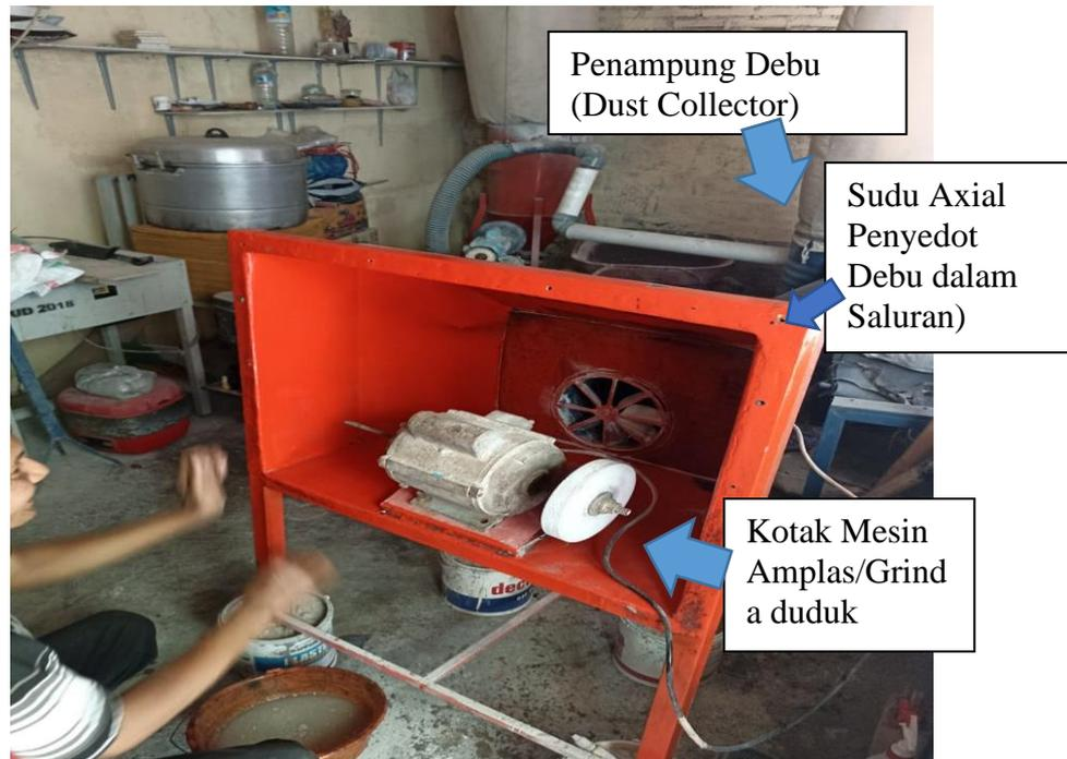
Gambar 3 Instalasi Penyedot Debu Yang sudah selesai di modifikasi di Mitra UKM “YANTO”
