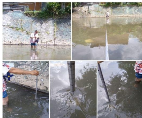
Gambar 3 Pengukuran penampang aliran Sungai Ancar.
