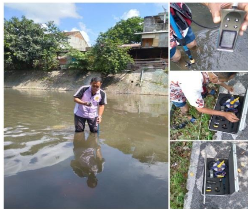
Gambar 2 Pengukuran kecepatan aliran Sungai Ancar dengan current meter digital .
